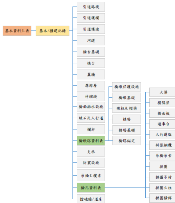
圖 3 TBMS2 橋梁基本資料表架構圖
