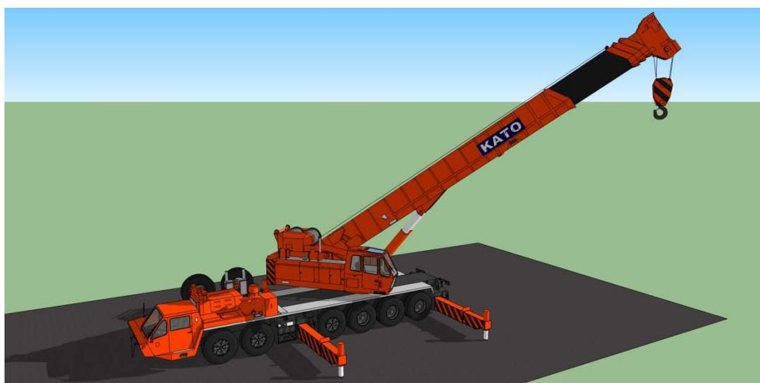
上頁前 6 張小圖就是連續用滑鼠左鍵雙點吊桿所顯示的畫面，畫面清楚部分就是此階段被點選的模組，也就是此時可以去拉伸或旋轉的桿件，淡色部分則是不會被編輯到的構件。整部吊車車頭方向可先朝 X 或 Y 軸方向，比較方便調整吊桿仰角及各節吊桿拉伸長度及吊勾下垂方向，以及吊桿下油壓桿件之調整。撐腳也可以拉開到需要長度。然後才去依吊桿及操控台旋轉軸去旋轉移動吊桿方向。最後一張就是調整後的完成圖，還蠻逼真的。
